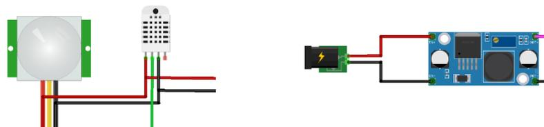
Gambar 5. Blok Input Tegangan dan Blok Input Sensor
