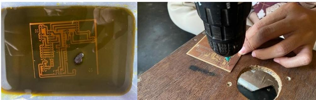
**Gambar 9.** Pelarutan dan Pengeboran PCB
